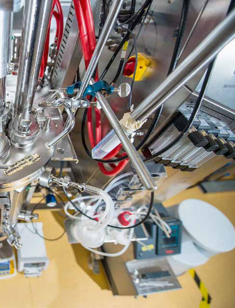
Optische Fasern, die als Lichtwellenleiter für die PDW-Spektroskopie eingesetzt werden
